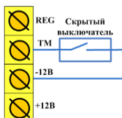
Рис. 10.5. Схема подключения скрытого выключателя
