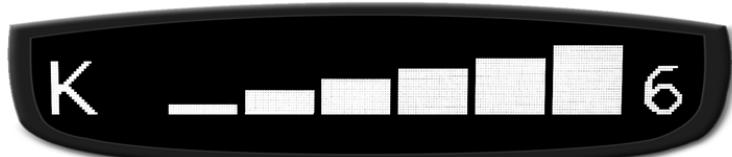
*На рисунке: Информация на дисплее при обнаружении радарного сигнала среднего уровня мощности, работающего в диапазоне K:*
