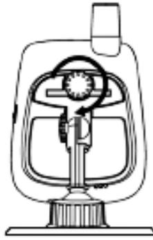
В. Два шарнирных соединения позволяют настроить угол наклона монитора.
