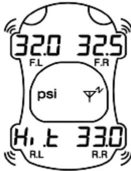
При увеличении температуры на каждый следующий градус звуковые сигналы будут повторяться, пока температура в шине не достигнет номинального значения.
