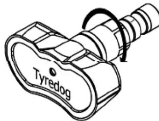
6. Установите датчик на обод в направлении, показанном на рисунке (вставьте ниппель датчика в отверстие на ободе колеса так, чтобы основная часть датчика плотно прижалась к внутренней поверхности обода колеса).
