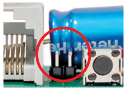
Джампер удален = энергосберегающий режим
