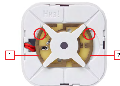
Замыкание контактов 1 и 2 для прописки датчиков
