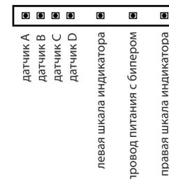
Система может работать как с четырьмя, так и с двумя датчиками. Чтобы система парковки функционировала как 2-хдатчиковая, необходимо не подключать либо два средних датчика (A и D), либо два крайних (B и C).
