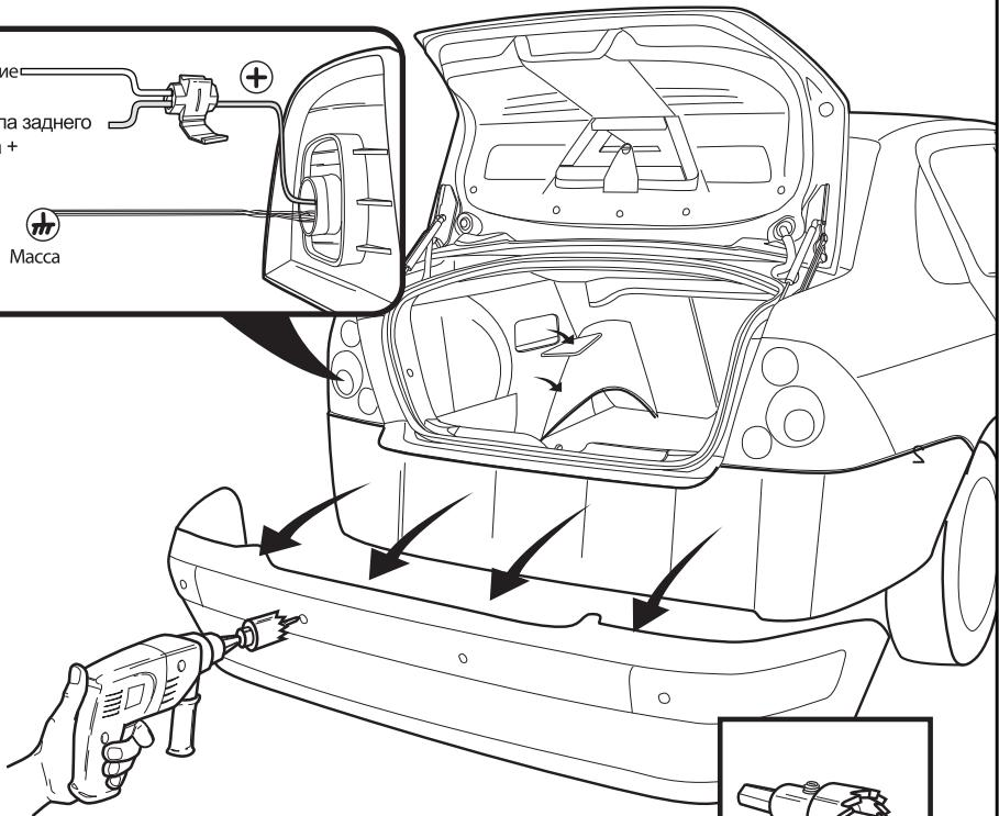
Перед работой проверьте, чтобы диаметр датчика совпадал с диаметром фрезы.
