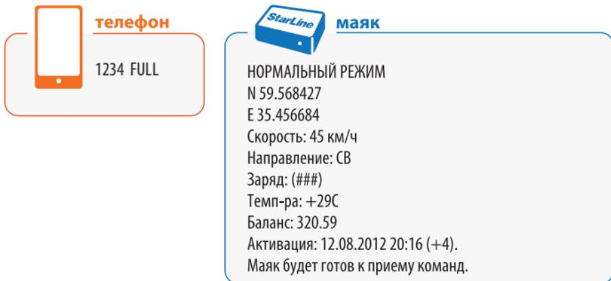
При невозможности определения координат по сигналам GPS будет произведена отправка идентификаторов базовых станций GSM аналогично случаю запроса координат в стандартном формате.
