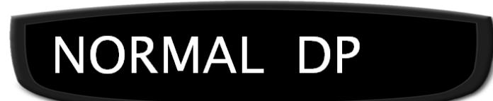
В этом режиме ( заводская установка) при обнаружении сигнала радара на дисплей после названия диапазона будут выведены графический и цифровой индикаторы уровня обнаруженного сигнала.
